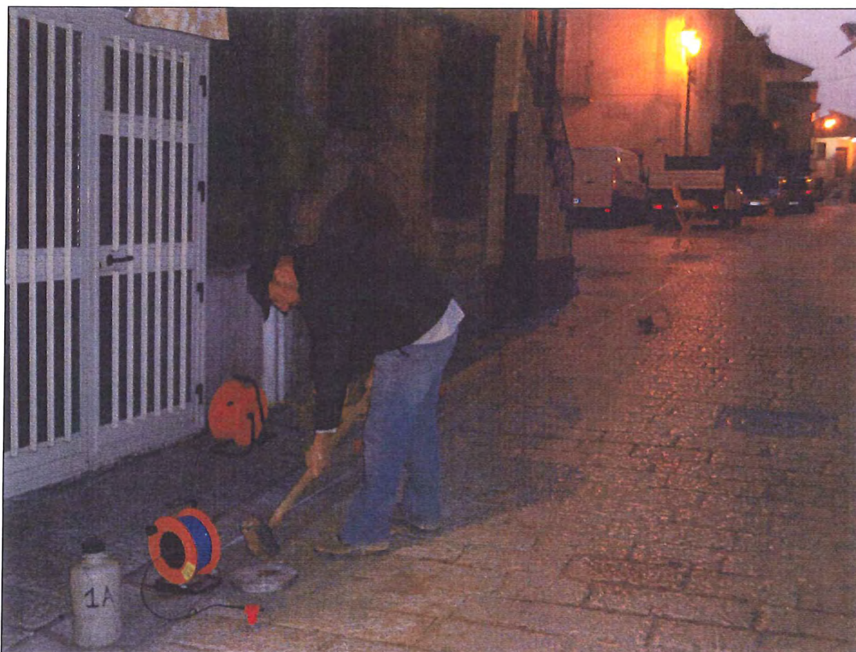
Foto 3. Punto di energizzazione
