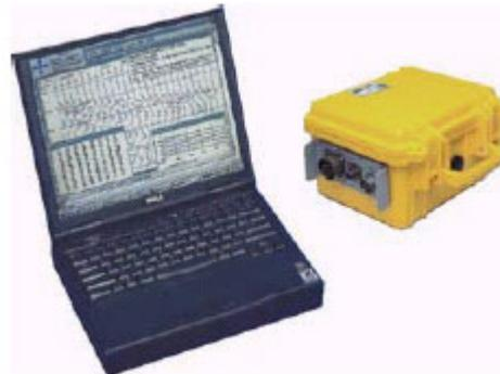
L'apparecchiatura è dotata di incremento automatico del segnale con algoritmo di sommatoria e consente la visione in simultanea dei dati sullo schermo del computer. Si può, inoltre, manipolare il segnale con appositi di filtri, verificare il livello di rumori generati da sorgenti estranee (vento, rumori naturali, mezzi meccanici, ecc.) e scegliere l'amplificazione più idonea del segnale.
